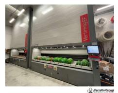
Questi sistemi sono in grado di stoccare e gestire materiali di peso e dimensioni considerevoli permettendo di sfruttare al massimo lo spazio in altezza e riducendo ad un decimo la superficie occupata rispetto ad un magazzino tradizionale.
